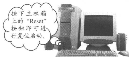
**提个醒** 复位启动必须在电脑已经开启的情况下进行操作。若电脑未开机，则无法使用复位启动方法。
