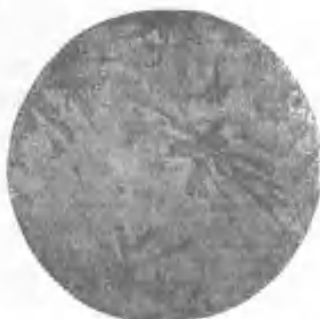
圖 6 含鐵 3.5% 的鋁合金 \times 104
