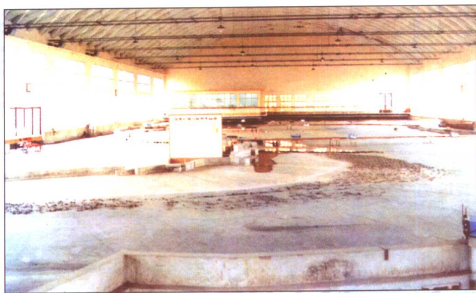
研究河口整治方案的动床模型
