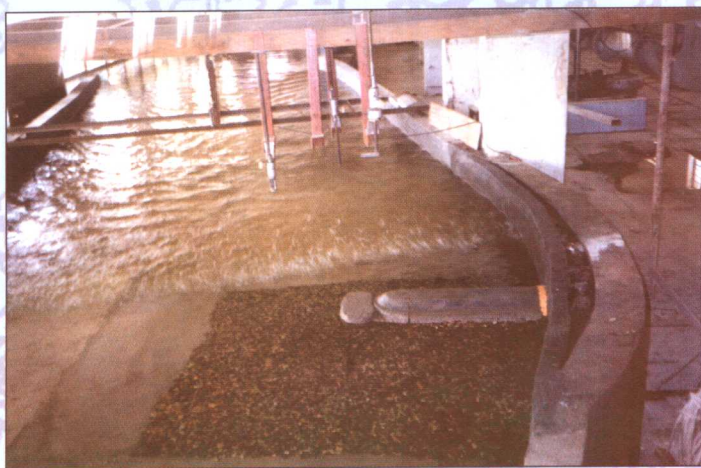
在涌潮水槽中进行丁坝坝头的冲刷试验
