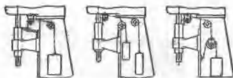
圖6 用重錘平衡鑽軸和支架。
