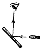
圖 17 水下觀測筒中 光線進行路程
