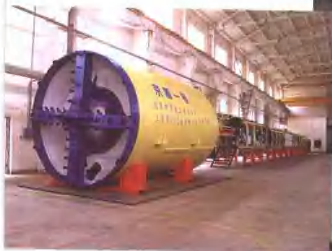
大型盾构机“京盾 一号”外观。
