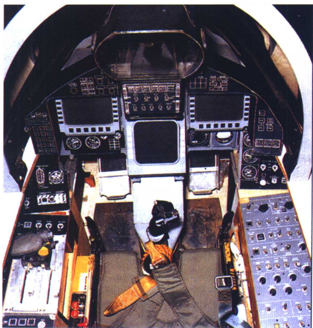
AST 计划方案的 EAP 战斗机座舱布局
