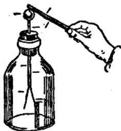
图 2-3 检验胶木棒带电
