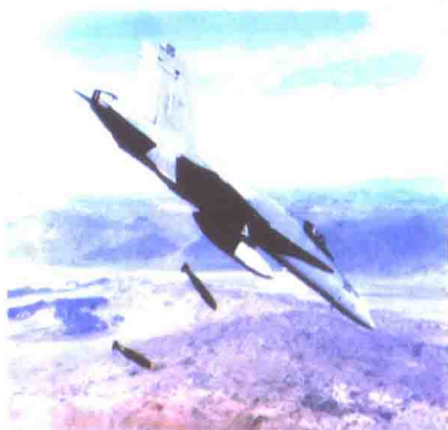
一架F/A-18于浅角度俯冲攻击中投下一对82型低阻力炸弹
