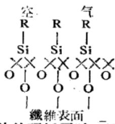
这样，当用蒸气法处理紙頁时，甲基三氯硅烷在纤维的表面上和孔隙中，由于憎水碳氢基 ( $\text{CH}_3$ ) 的关系，对水就产生了一种斥力，因之，保护了纤维，使之不受水的作用。
