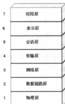
图 1-3 OSI 七层模型
