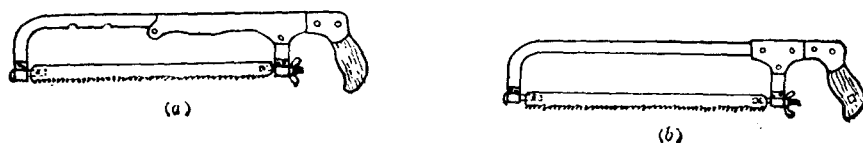
图 1-1 钢锯架 (a)活动锯架；(b)固定锯架
