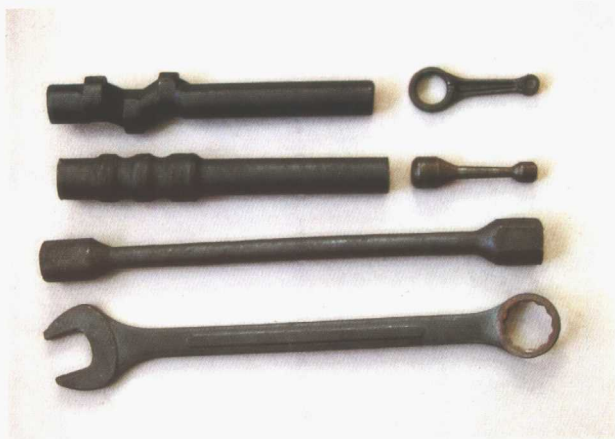
图1-27 楔横轧制坯模锻成形的连杆、曲柄与五金工具零件
