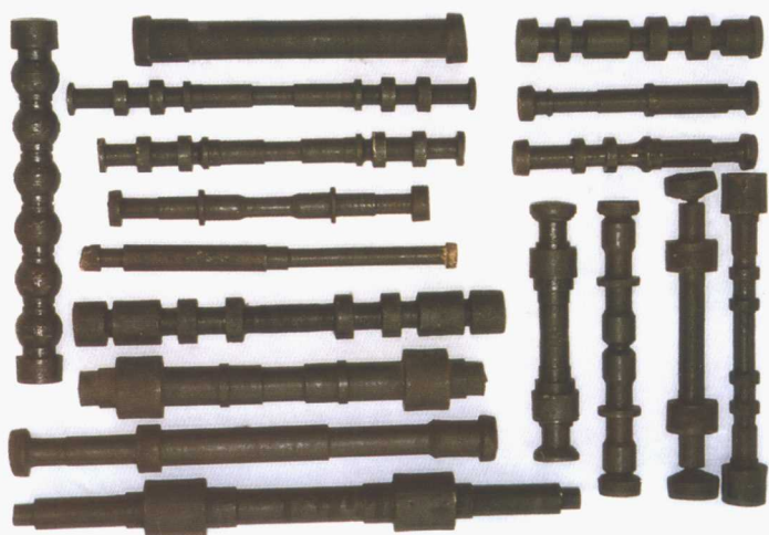
图 1-18 我国生产的楔横轧拖拉机轴类零件
