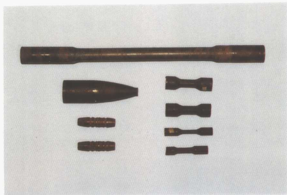
图 1-24 我国生产的楔横轧空心零件
