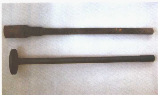
图 1-28 楔横轧与摆辗结合生产的汽车半轴零件
