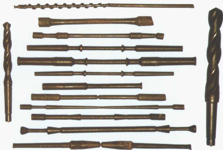
图 1-21 我国生产的楔横轧五金工具毛坯
