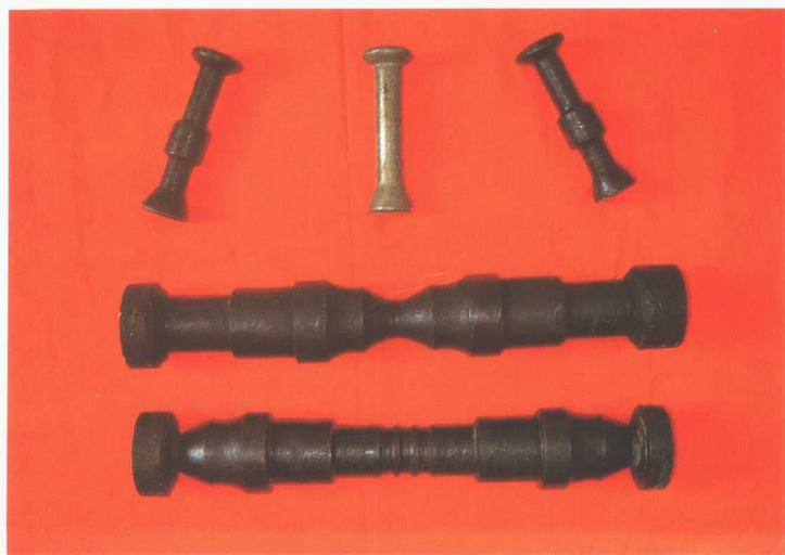
图 1-23 我国生产的楔横轧电磁铁角、截齿刀体
