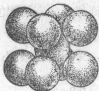
图 6 体心立方单元晶胞内原子的排列。
