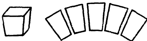
图 2-3 楔形耐火砖嵌砌拱顶示意图
