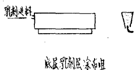
图 2—15 底层、乳剂层涂布嘴形式
