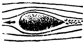
圖 2. 在運動物體的後面，造成一條渦流。造成的渦流越大，阻力就越大。
