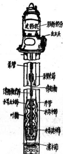
圖6 深井泵結構簡圖
