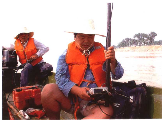
GPS全球定位系统用于水沙测验及淤积断面测量 (龙 虎 摄)
