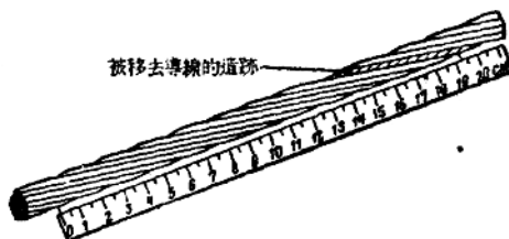
圖1b 用自一層中移去一導線的方法決定節距
