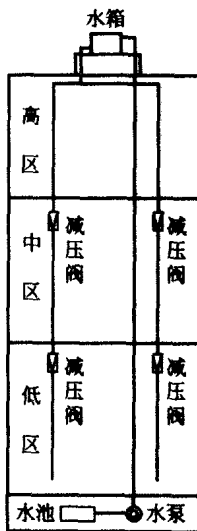
图 1-6 垂直立管循序减压给水方式
