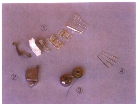
3. ①各种压脚②缉止口吸铁③梭壳、梭芯④缝纫机针
