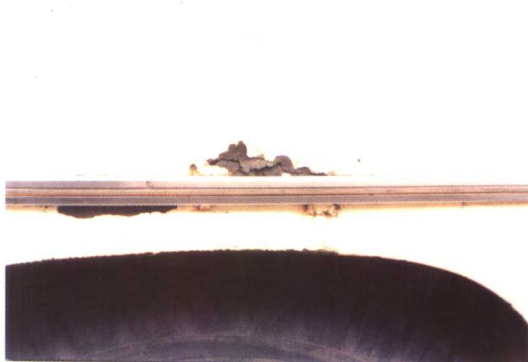
图 4-11 装饰条附近的穿透腐蚀(第 62 页)
