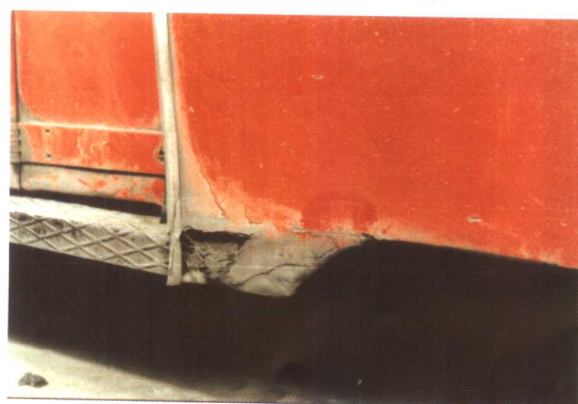
图 4-6 车门踏脚附近面板的腐蚀穿透(第 62 页)
