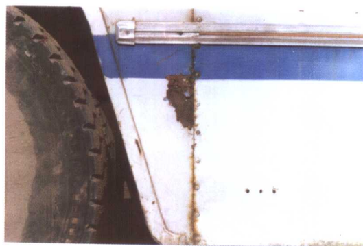
图 4-4 铆接造成的缝隙腐蚀(第 62 页)
