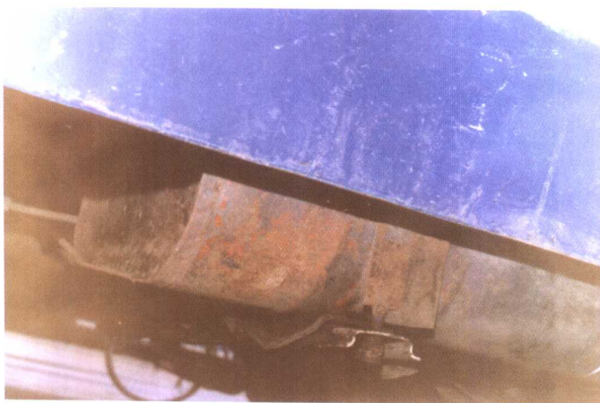
图 4-17 燃油箱外侧腐蚀(第 64 页)
