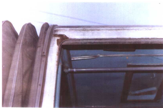
图 4-10 车窗框焊接处腐蚀和裂纹(第 62 页)
