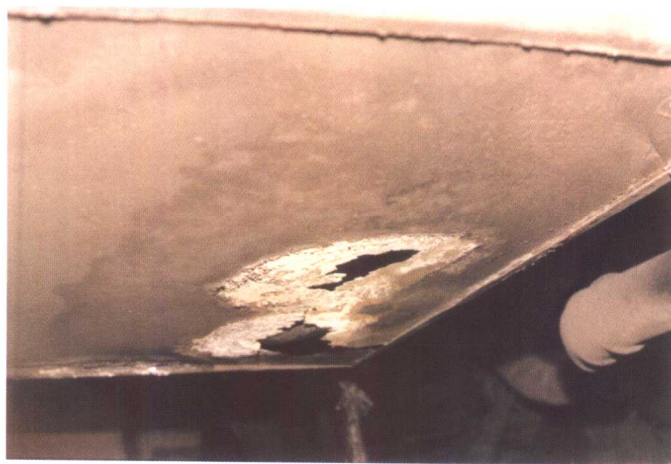
图 4-18 电瓶箱腐蚀穿透(第 64 页)
