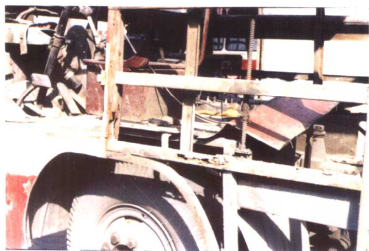
图 4-12 车轮附近骨架腐蚀穿透(第 62 页)
