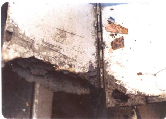
图 4-7 车门下部腐蚀穿透(第 62 页)
