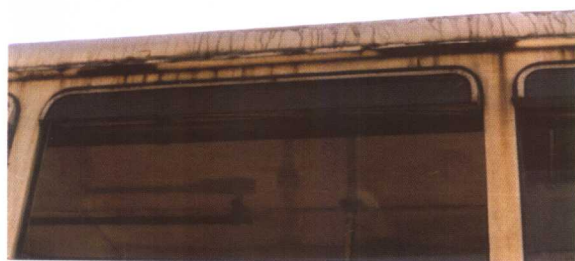
图 4-14 汽车导水槽的腐蚀(第 63 页)
