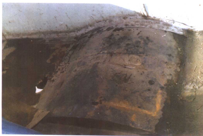
图 4-21 脚踏地板腐蚀穿透(第 66 页)
