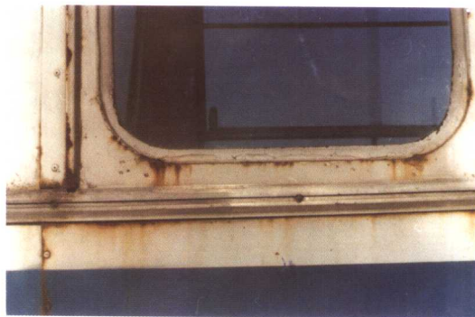
图 4-9 窗框与密封橡胶条间的腐蚀(第 62 页)
