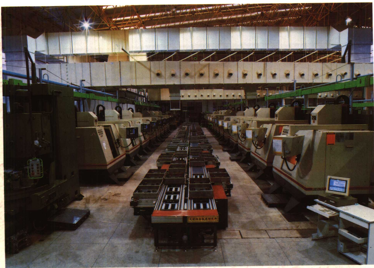
北京市机电研究院 1996年设计制造的摩托车曲轴箱体柔性加工线
