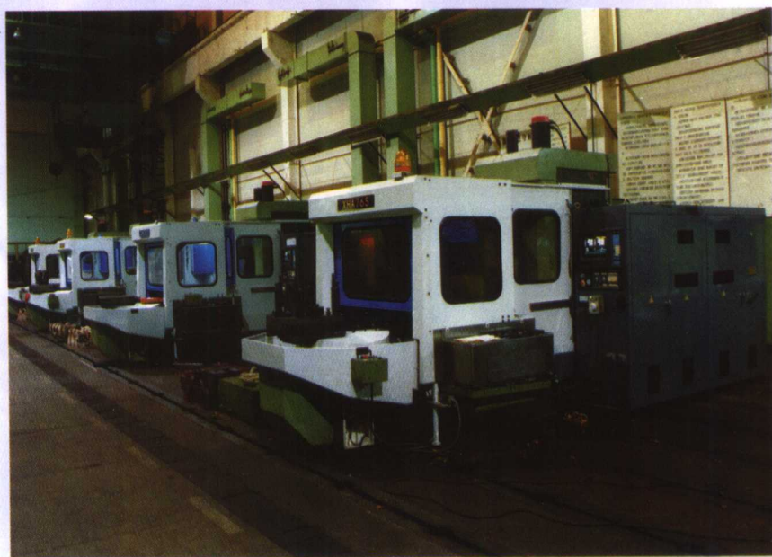
1998年北京第一机床厂 XHA765型卧式加工中心装配 现场
