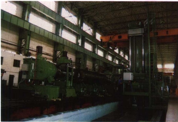
北京重型电机厂在数控机床上加工发电机转子槽
