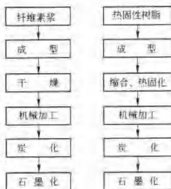
图1 玻璃炭工艺流程图
