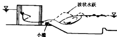
图10 平台小槛改变流态示意图
