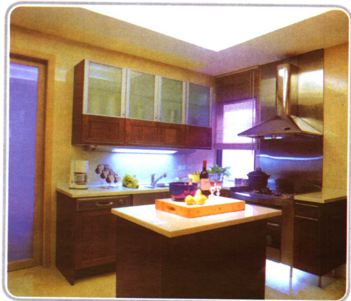
★ 彩图 18 厨房。厨房照明，最重要的是要有足够的照度，即所谓“明厨出佳肴”。洗菜池和操作台更是厨房照明的重点区域。厨房照明方式通常是在顶部安装吸顶灯、嵌入式灯具或设置发光顶棚。
