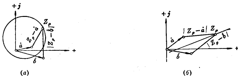
图 7-14 阻抗复数平面上，比较两个电气量的继电器动作边界线
