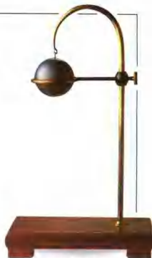
十九世纪后期用以显示 热使固体膨胀的装置
