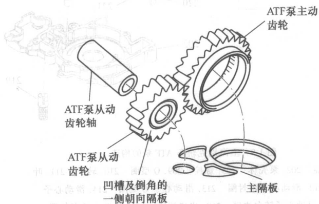
图 1-7 外齿轮啮合式 ATF 泵的构造
