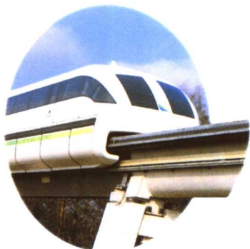
磁浮机车应用电磁原理“浮”在铁轨上方，而不是接触铁轨行驶。
