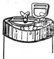
圖 2 打气筒頸圈螺絲和加水盖漏气情形。
