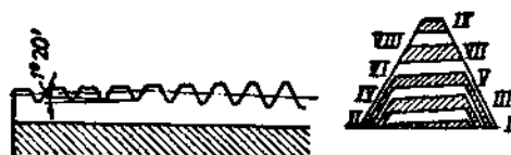
圖12 板牙絲錐切削部分上工作載荷分佈圖。
