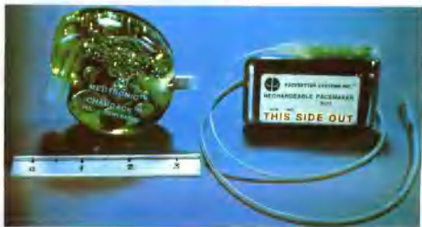
起搏器可根据血液的温度来调节心跳。1988年一位病人安装了一个核动力起搏器，这个起搏器上使用了微量的钚，所以它可以持续应用20年。
