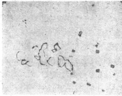
图1. 椭圆形的UO夹杂(亮的)及UC的立方体(黑色). 浸蚀剂—50%硝酸.( \times 400 )
