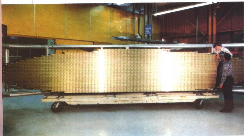
美国 AN/APY-1/2 预警和控制系统雷达天线在转运车上
