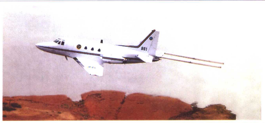
瑞典 Carabas 超宽带合成孔径雷达在飞机上
