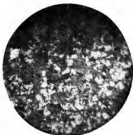
图4,a 碱度0.87,磁铁矿不规则粒状晶体反光(放大225倍)
