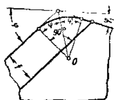
圖28 帶有稜面的車刀的切削刃間的連接線。
