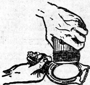
圖 7. 拆環器拆下活塞環
