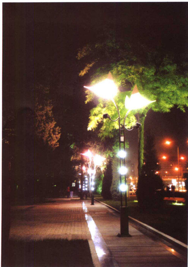
图1-34 步道灯具兼顾了地面照明、空间照明、自身造型以及树木照明等几个方面的要求
