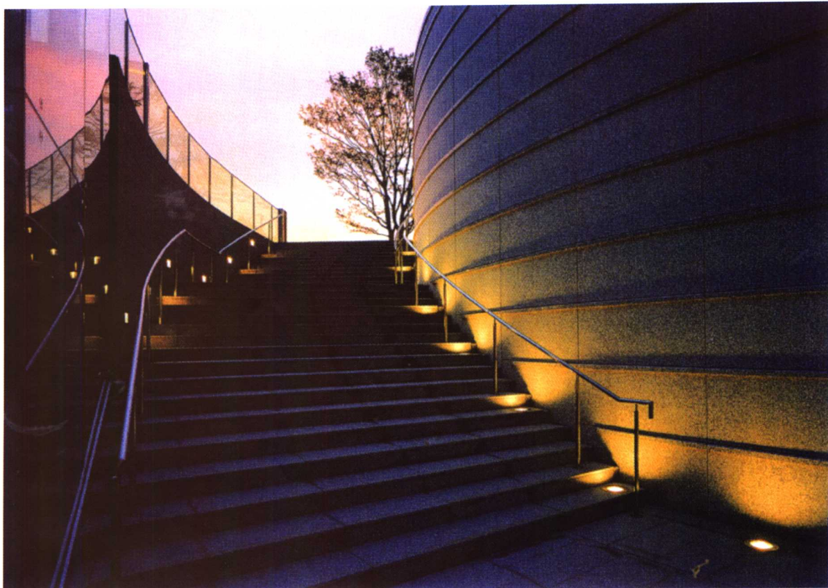
▲ 图1-17 借助于对台阶踢板和侧墙的照明,构成步行阶梯的灯光景观,使简单的功能性照明产生了良好的装饰效果,同时,静谧的氛围也体现了在步行空间中对人的尊重
