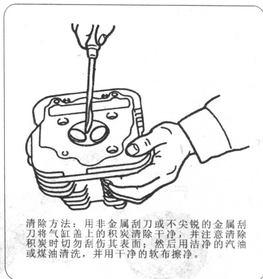
图 1-1 清除气缸盖燃烧室内的积炭
