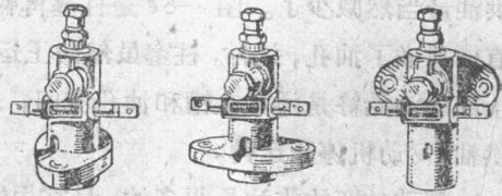
图 1-11 标准形式的单体射油泵
