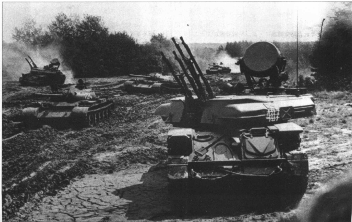
苏制ZSU-23-4型23mm四联装自行高射炮。该炮同样可以伴随快速运动的机械化部队。这种自行高射炮在1973年的中东战争中取得了重大的战果——以色列飞机在萨姆导弹的威胁下不得不低空飞行，于是成为了这种高射炮的最佳射击目标。
