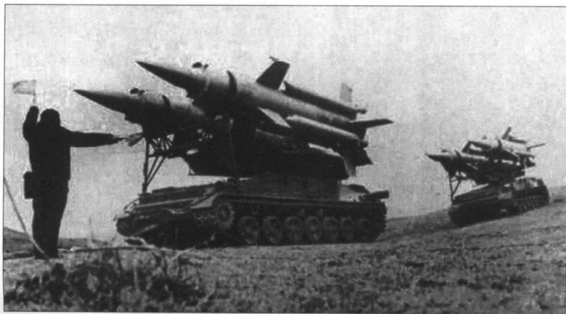
萨姆-6导弹身材壮硕的兄长：苏制萨姆-4远程防空导弹，最大射程为74千米。由于同样实现了车载化，这种导弹在苏军中通常和萨姆-6混合编组，但在中东，这种导弹却很少见。
