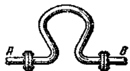
圖 1-3. 蒸汽管中裝置着的膨脹圈,使管 A 和管 B 間得以自由地伸縮。
