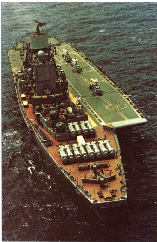
俄罗斯基辅级航母为了飞机迅速起飞或着陆的拐角式甲板。
