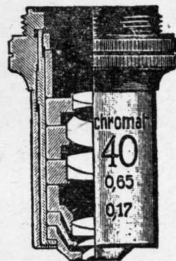
圖 4·3·5 平面用消色差物鏡之實體剖面
