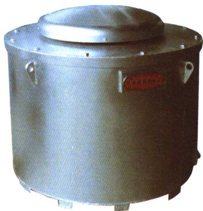
加蓋式溶解保溫爐 能節省能源
