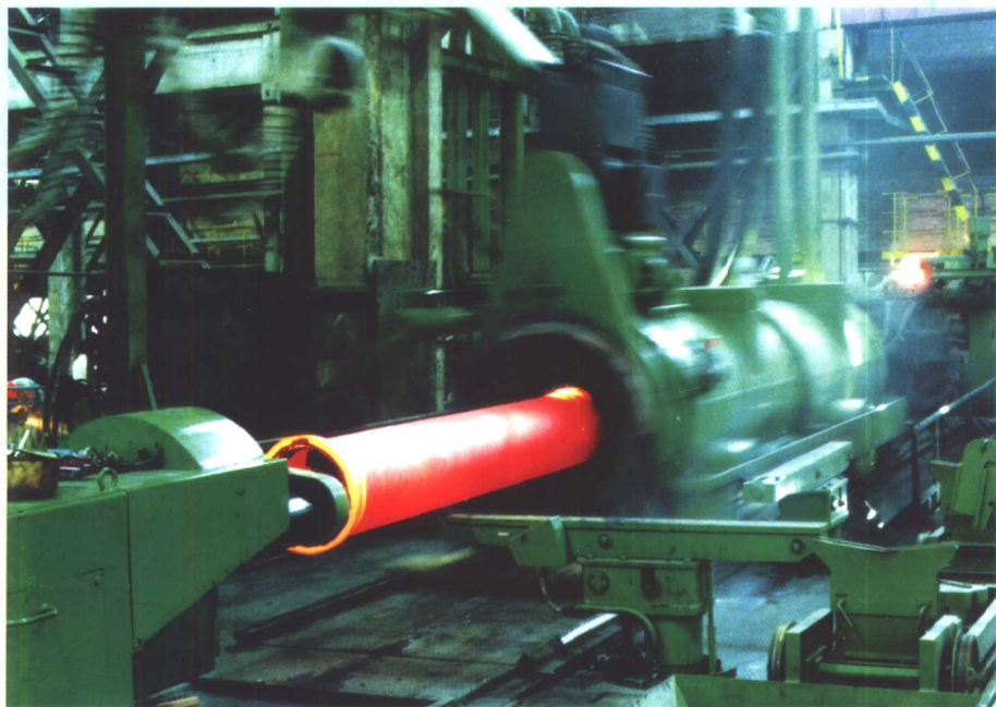
水冷金属型离心铸管机拉管过程
