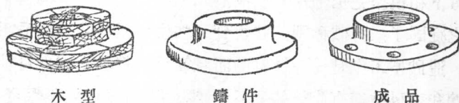
圖六 一個「法藍盤」的木型、鑄造毛坯和成品。
