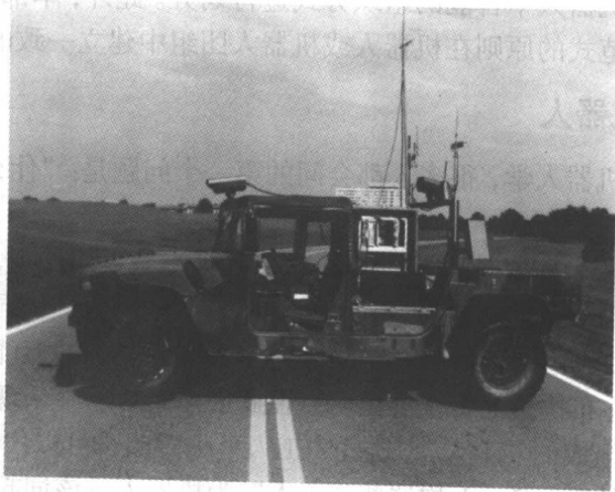
(b) 能在道路上和开阔地带行驶的HMMWV军队车辆(图片由美国国家标准技术研究所友情提供)
